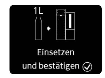
Sobald der automatische Vorgang abgeschlossen ist, ersetzen Sie die Spezial-Entkalkungspatrone (SDC) durch die Original-Filterpatrone.
