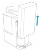
Öffnen Sie die hintere Abdeckung. Heben Sie sie an, um die Haken zu : Drücken Sie die Hebel nach oben, um die Filterpatronen einzusetzen. entriegeln.
